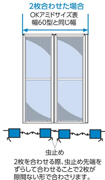
2枚を合わせる際、虫止め先端をずらして合わせることで2枚が隙間ない形で合わさります。
