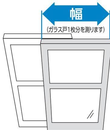
幅はガラス戸1枚の幅寸法が865~845mmの範囲であれば取付けできます。
