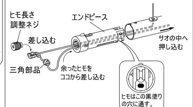
5 ポッチを押しながら、エンドピースを元通りに入れ込みます。その後、ヒモをサオに押し込みながら、ヒモ長さ調整ネジを左まわしてねじ込んでください。
