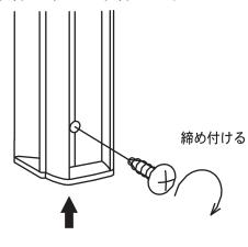
5 切捨て寸法が18cm以上の場合、フック取付穴より 切捨て寸法 2 上に2.5~3.0mmの下穴をあけ、 フックを取付け直します。
