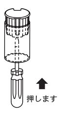
長さ調整した巻軸に キャップを取付けます。
