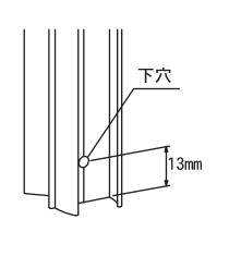
4 タテ桟の下端部に下キャップを 取付けネジで取付けます。
