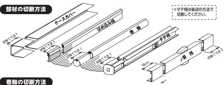
巻軸の端部から「切り捨て寸法」 を切断します。
