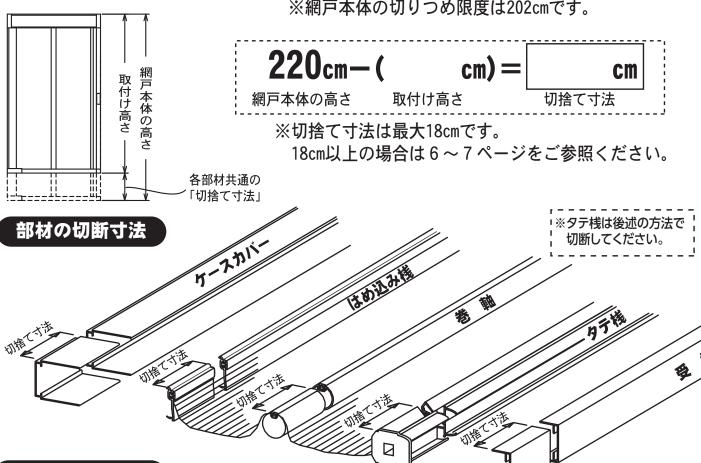
巻軸の端部から「切り捨て寸法」 を切断します。
