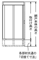
※切捨て寸法が18cm以上の場合は「切捨て寸法 1」と「切捨て寸法 2」を 算出します。
