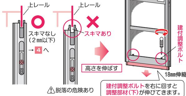
上レールとの間にスキマができた場合は、**1**の固定ビスをゆるめた状態で、**建付調整ボルト**を左右2本とも右に回し、高さを伸ばしてください。
