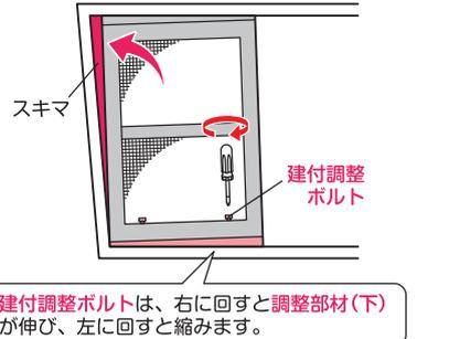
図のようなスキマができた場合は、**建付調整ボルト**を片側ずつ回し、左右の高さを変えてスキマをなくしてください。( **1** の固定ビスをゆるめた状態で)
