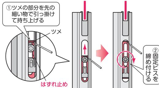
虫止め上部の穴の中にある**はずれ止め**(金具)を、アミドの開閉に支障のない範囲でいっぱいへ上げ、上の**固定ビス**を締めて固定してください。(両側とも上げてください。)
