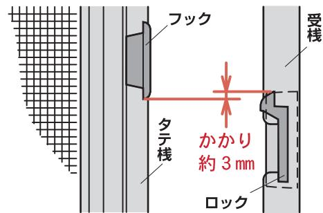
かかりが約3mmになるようにフックをずらして調整してください。再びネジを締め直します。
