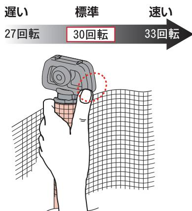
3 巻き終えたら図の方向から見える隙間に回転止め金具を挿入します。
