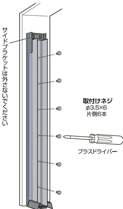
**⑫** 樹脂枠から **⑬** ケースカバーと **⑭** 受棧の取付けネジをドライバーを使って外してください。
