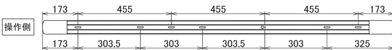
**注意** 本体取付ネジは必ず天井材すぐ裏の野縁に効かせてください。
