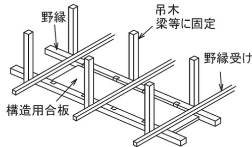
(例) 野縁材の補強例
