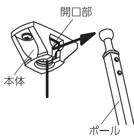
ポールを持ち上げ、上へ押し当てて本体側面の開口部から外します。
