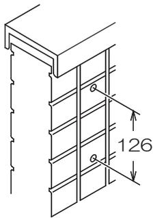
製品を取付けるための下穴をφ6mm、深さ85mmで2ヶ所正確にあけて下さい。
