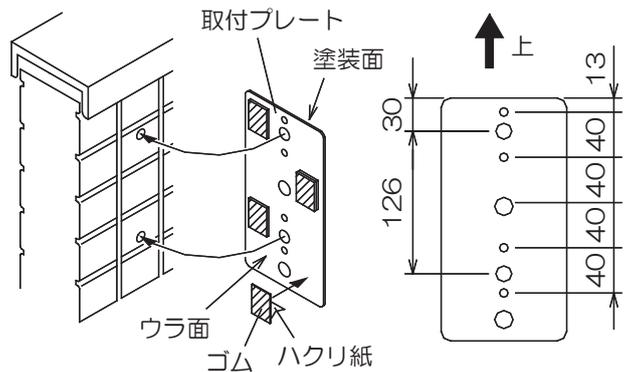
下穴に合わせて取付プレートを実際に当てがい、凸凹面に応じて適宜ゴムを切って貼付けて下さい。
