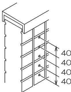
製品を取付けるための下穴をφ3mm、深さ55mmで5ヶ所正確にあけて下さい。
