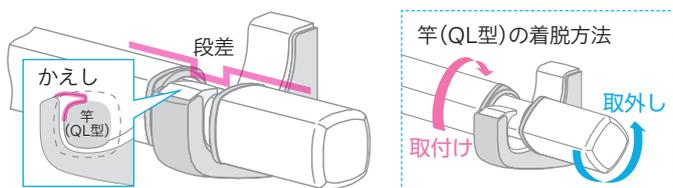
フック(QLH型)に設けられた「かえし」によって竿が抜けにくく、さらに竿(QL型)に設けられた「段差」で竿が脱落しにくい構造です。竿の着脱は回転させながら行う操作です。
