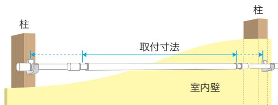
竿(QL型)の長さを調整することで、掛ける物の量や下地材の間隔等に合わせてフック(QLH型)の取付寸法を柔軟に対応させることができます。 ※石こうボードのみには取付けできません。
