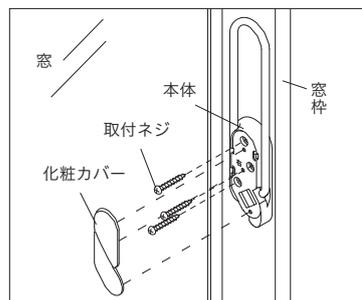
付属のネジで窓枠に取付けできます。
