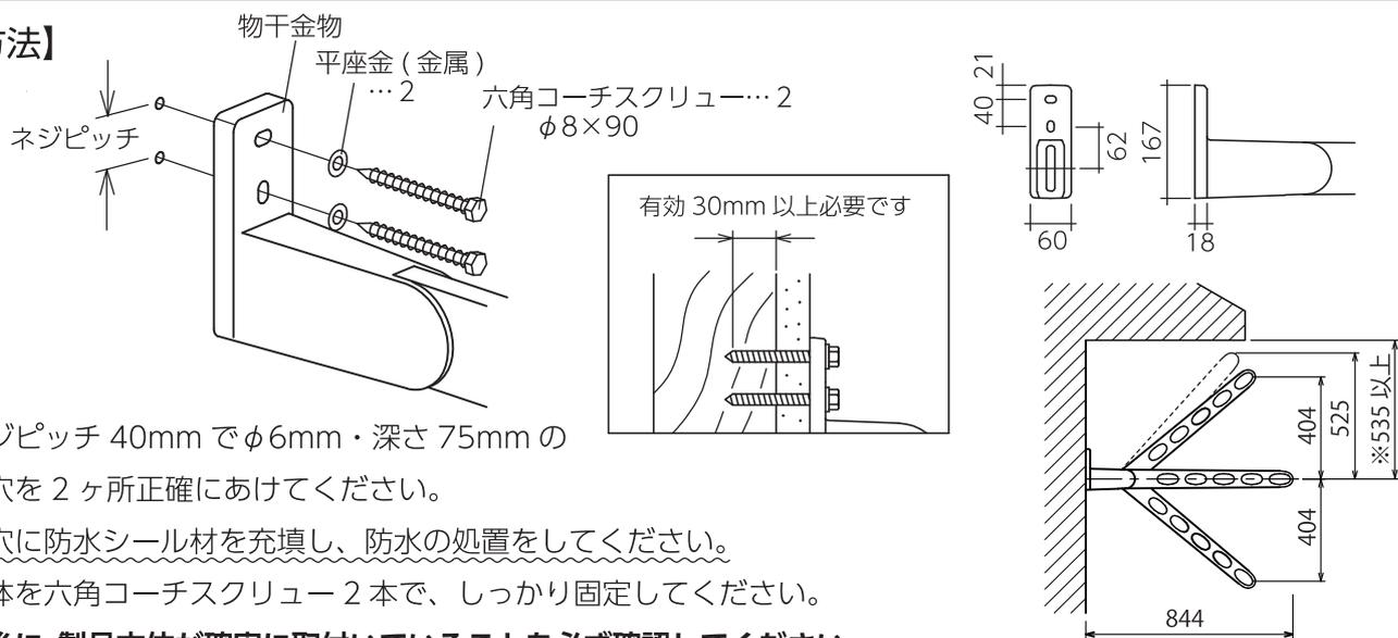
①ネジピッチ 40mm でφ6mm・深さ 75mm の下穴を 2ヶ所正確にあけてください。
