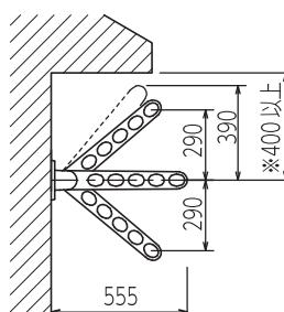
①ネジピッチ 122mm で  $\phi 6$ mm・深さ 75mm の下穴を 2ヶ所
