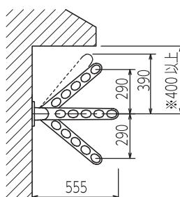
①ネジピッチ 122mm でφ6mm・深さ 75mm の下穴を 2ヶ所
