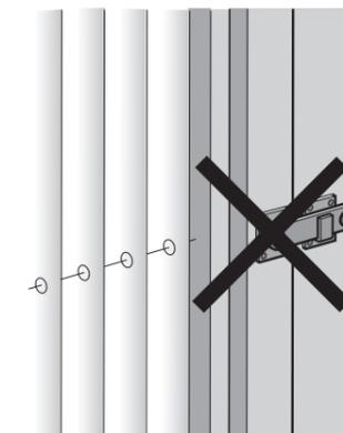
A6, A7. この製品は構造上スライドバーや収納枠の内側にスコピオンテイルが収納されます。型材（アルミ材）に穴をあけたり、ねじを使って取っ手や鍵を取り付けしないでください。ねじを取り付けなくても動かない場合は型材の凹みが原因の場合は製品本体を交換することになります。販売店にお問い合わせください。
