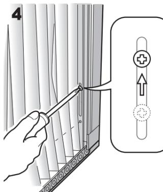
4 最上部、最下部の調整ねじをワイヤーの張る方向に調整し固定します。(ワイヤー配線図参照)
