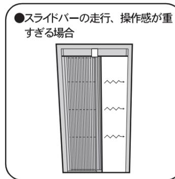
ワイヤーがきつくなると操作感が重くなります。左面、ワイヤー調整を参照の上、ワイヤーをゆるめる調整をしてください。
