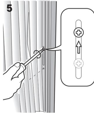
5 中間の調整ねじを最上部、最下部と同じように調整し固定します。
