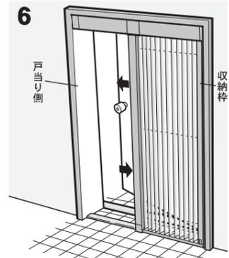
6 スライドバーを動かし、戸当り側、収納枠との平行、納まりを確認します。
