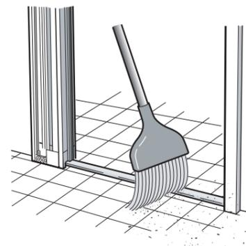
レール及びレールのまわりに小石、砂、ほこり、泥などがたまり、部品の摩擦や破損が起き、スムーズな開閉ができなくなります。汚れを取り除くためにこまめに掃除してください。できれば掃除機できれいにしてくださいと効果的です。
