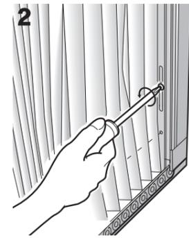
2 収納枠のプリーツネット側の調整ねじをドライバーを使用して全てゆるめます。
