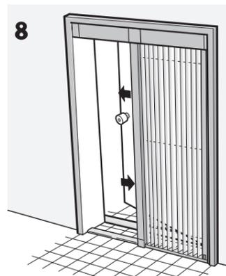
8 スライドバーを左右に動かし、走行、操作性を確認し、具合が良くなるまで調整します。
