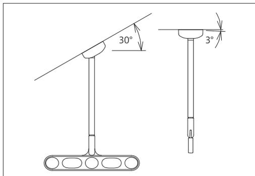
Z型は、傾斜面にも設置可能なベースを採用しています。
