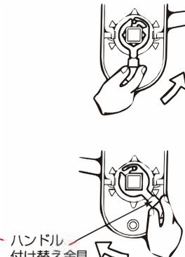
1. 「ハンドル付け替え金具」を反時計回転方向に回してはずします。
