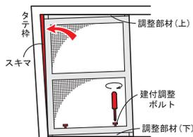
建付調整ボルトを片側ずつ回すと、調整部材(下)の左右のバランスで、タテ枠とのスキマをふさぐことができます。
