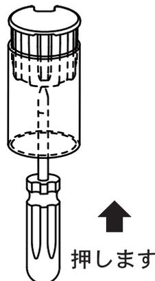
**3** 長さ調整した巻軸にキャップを取付けます。
