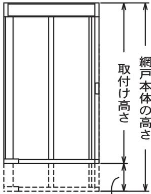
※切捨て寸法が18cm以上の場合は「切捨て寸法1」と「切捨て寸法2」を算出します。
