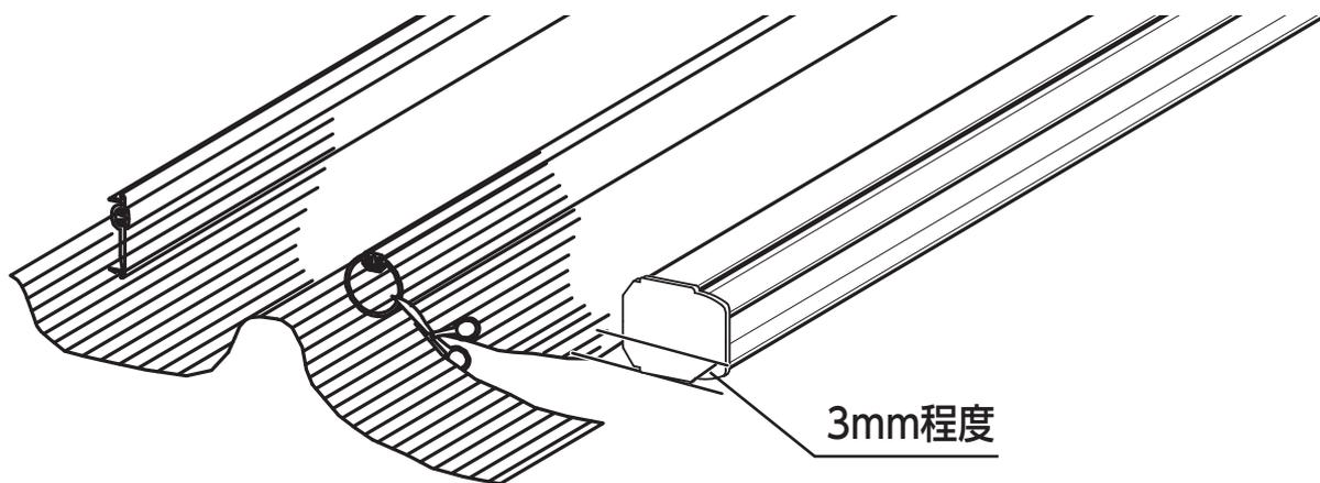
切断した各棧より3mm程度長くなるように網を切断します。
