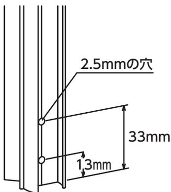
**4** 上側の穴に取付けネジを取付けます。
