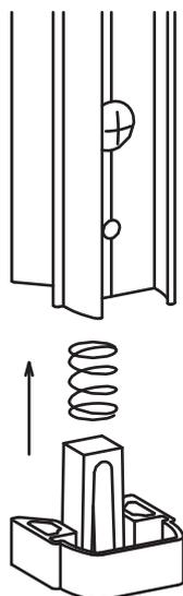
**6** 下キャップを押し付けながら、下側の取付けネジを取付けます。
