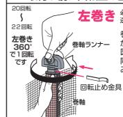
左巻き 必ず矢印の方向に巻いて下さい。 逆に巻くと故障の原因になります。
