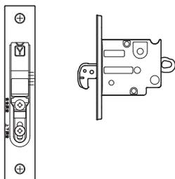
バックセット 38mm DY1鎌錠・ストライクセット
